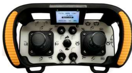
Aku pealt töötav kaugjuhtimispult (halli anduriga joystickud) võimaldab juhtida tõstukit nii traktori kabiinist kui ka tõstukist eemal olles. Juhtpult on kerge ja kompaktne ning on saa- daval kahe kiiruse funktsiooniga
