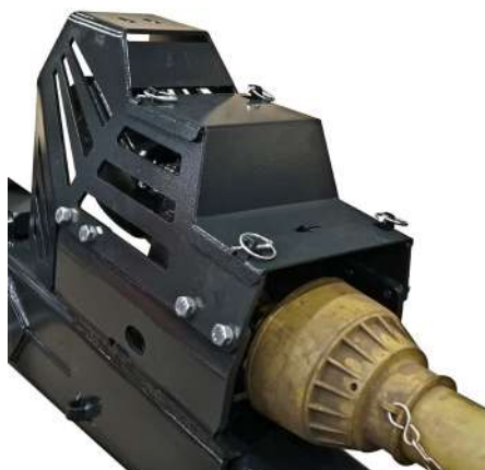
Kaitseraamiga pump ja reduktor tiisliil
