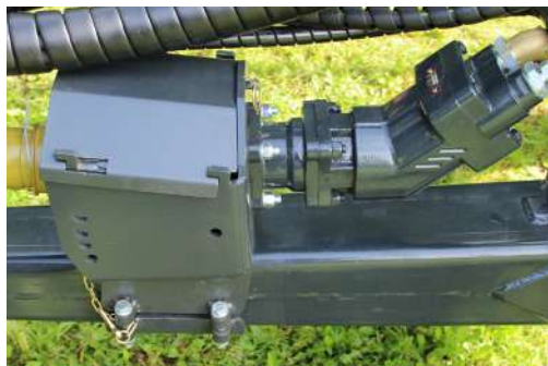
Pump ja reductor tiislii
